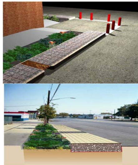
Figura 02. Se habría evitado, almacenado el agua en zona verde deprimida, e integrando el agua de lluvia con el paisaje urbano.
